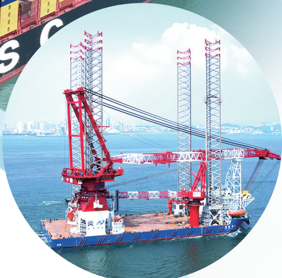
■“青岛造”国内综合性最强的第四代海上风电施工平台——“港航平5”。
