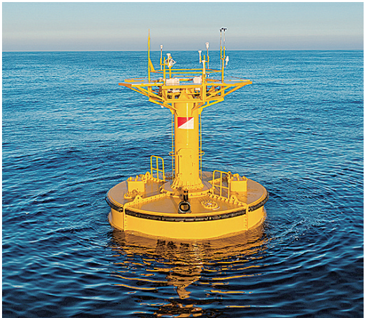
■青岛镭测创芯科技有限公司等单位研发出国产首台商用漂浮式测风激光雷达。
