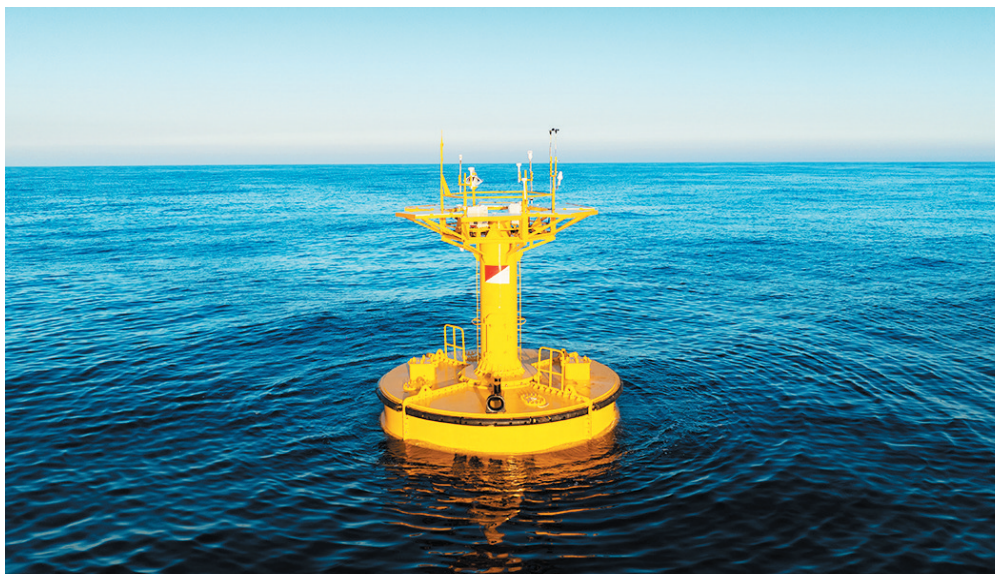
镭测创芯研发的漂浮式测风激光雷达系统,可为海上风资源勘测、海气边界层动力学研究及海洋数值天气预报提供宝贵的剖面观测数据。
