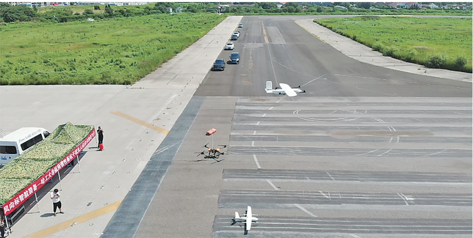
■中大型多任务载荷无人机在流亭机场实现惯性导航技术验证首飞。
