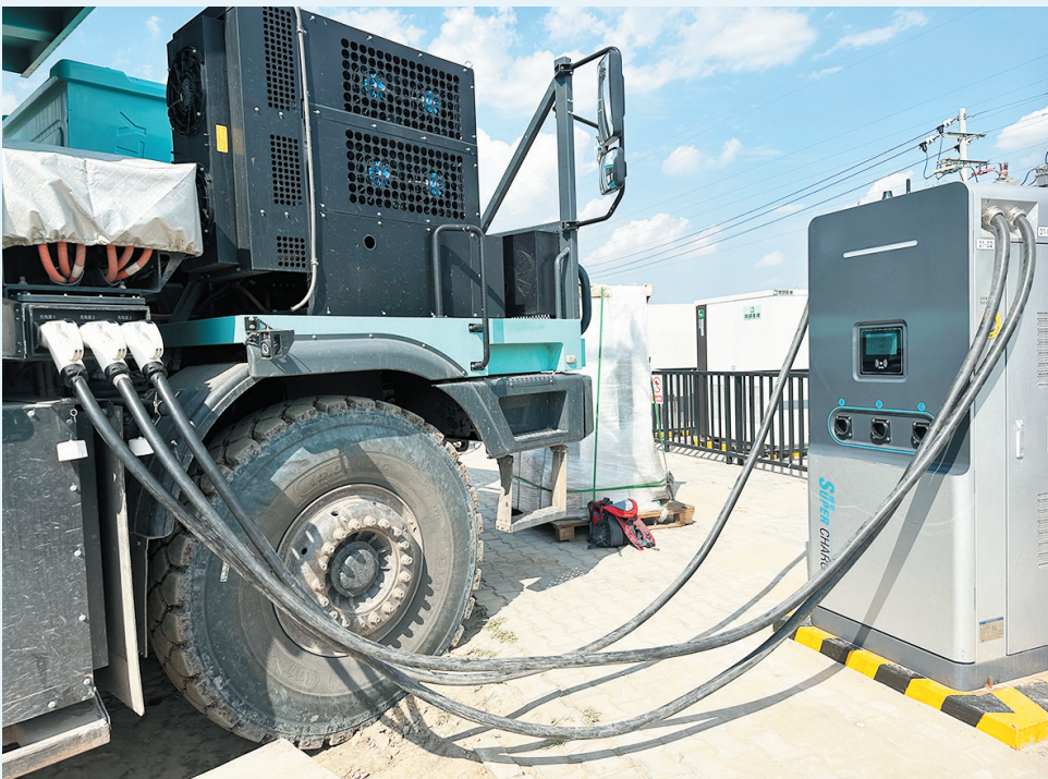
■海汇德单机输出功率1.8兆瓦充电桩在新能源重卡领域落地。
