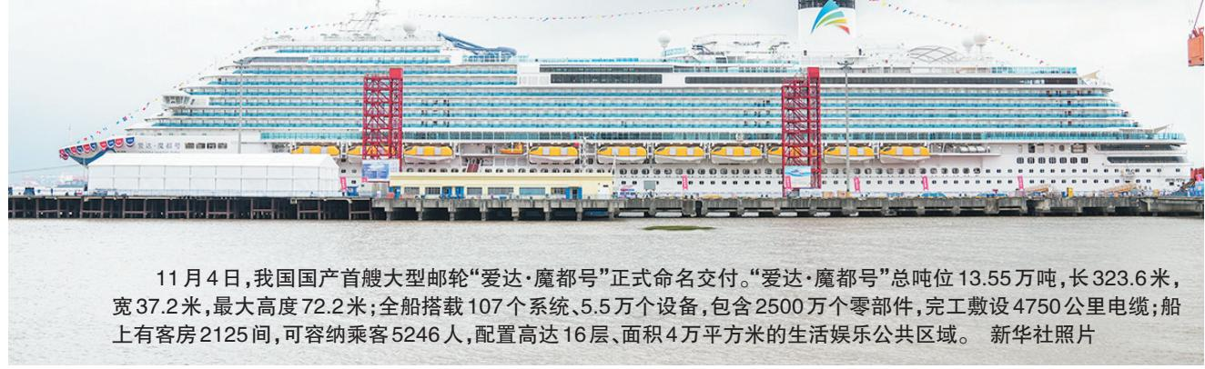
11月4日,我国国产首艘大型邮轮“爱达·魔都号”正式命名交付。“爱达·魔都号”总吨位13.55万吨,长323.6米,宽37.2米,最大高度72.2米;全船搭载107个系统、5.5万个设备,包含2500万个零部件,完工敷设4750公里电缆;船上有客房2125间,可容纳乘客5246人,配置高达16层、面积4万平方米的生活娱乐公共区域。新华社照片
