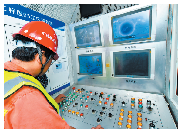
■驾驶室内,司机在操作盾构机。
