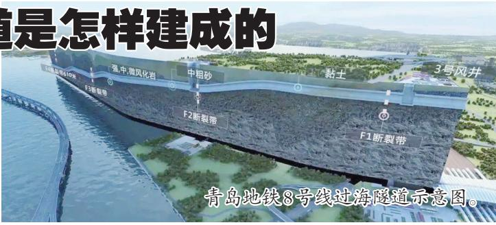
青岛地铁8号线过海隧道示意图。
