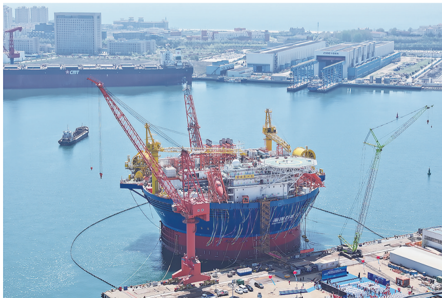
亚洲首艘圆筒型浮式生产储卸油装置(FPSO)。西海岸新区供图
