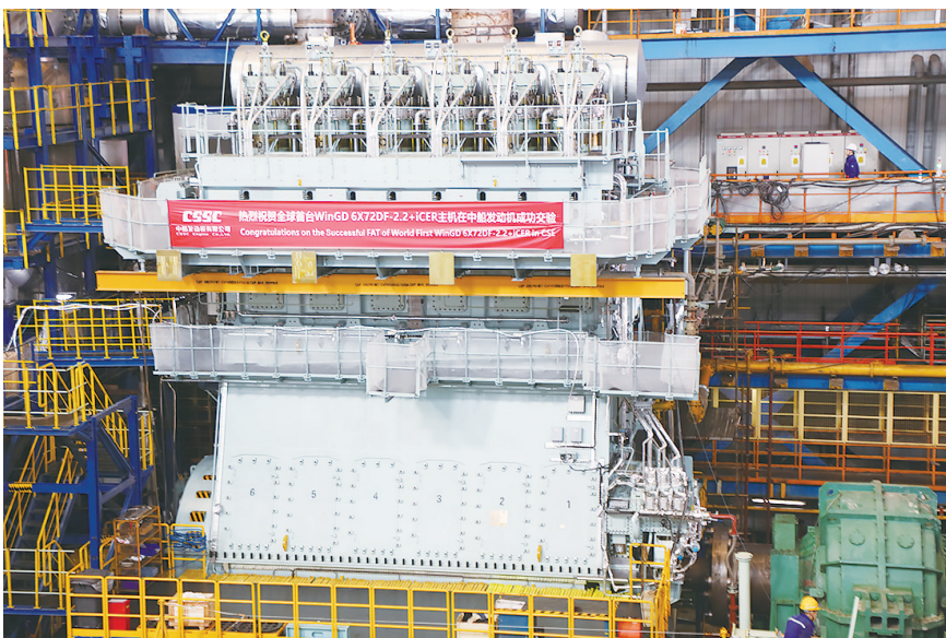
世界首台W6X72DF-2.2+iCER主机在中船发动机成功交验。
