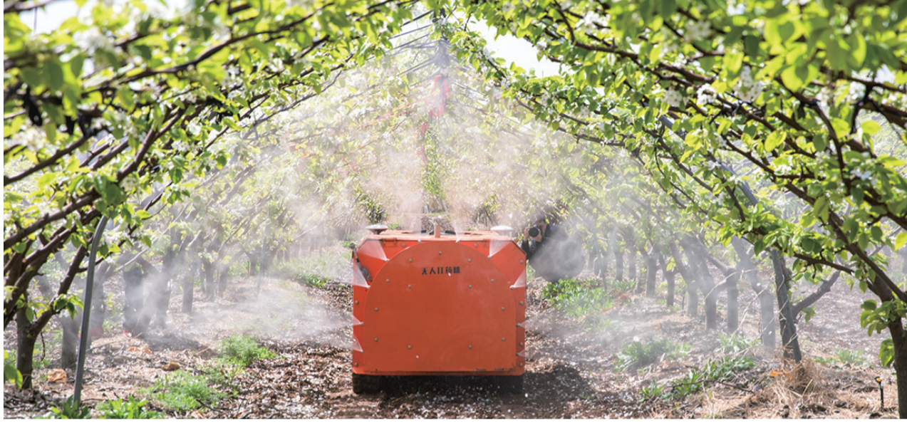
遥控风送式喷雾机正喷洒农药。刘明元 摄
