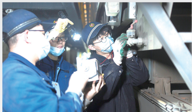
机械师对动车组外部进行检修。青岛动车段供图
